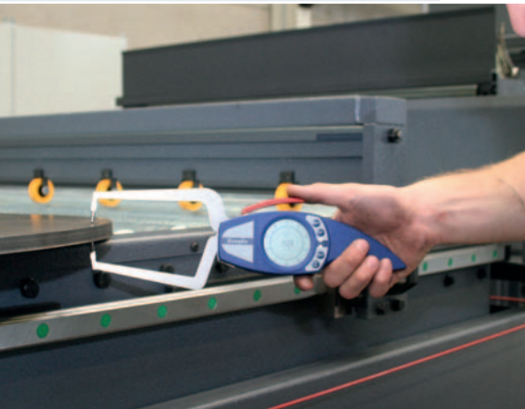
▲ Option Messzange: Cleveres Werkzeug für die automatische Blechdickenmessung.
